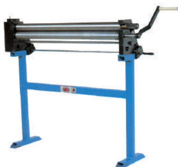
CILINDRO PARA CURVAR PLANCHA DE 1000 X 1,25 MM
